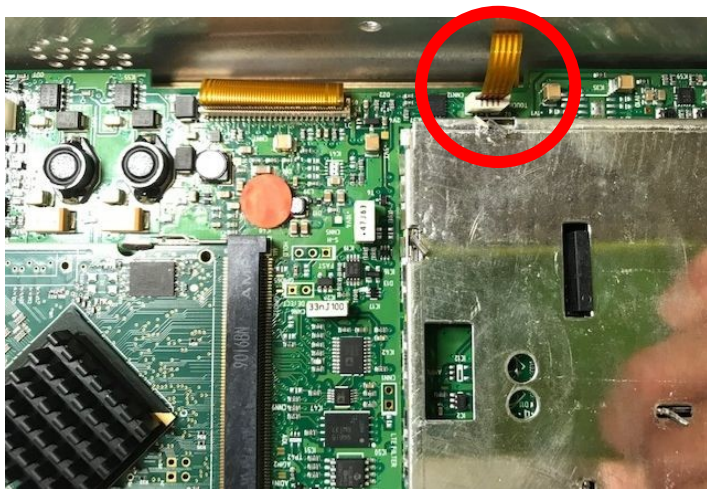
Fig.1 Vecchio display: Cavo Piatto del Touch screen
