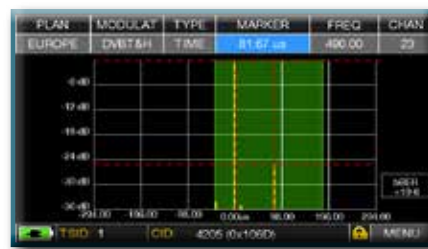
Fig. 2: BUONA RICEZIONE: * 2 ECHI presenti, ma all'interno della maschera nell'Intervallo di Guardia, provenienti da una distanza di: 1° eco: 24,50 Km, pari ad un ritardo di 81,67 \mu s .
