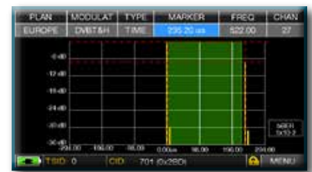
Fig. 3: RICEZIONE MARGINALE (o IMPOSSIBILE):* 2 ECHI presenti all'esterno della maschera dell' Intervallo di Guardia, provenienti da una distanza di: 1° eco: 70,56 Km, pari ad un ritardo di 232,20 \mu s .
