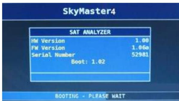
Fig. 3.1. La procedura di accensione mostra la versione HW, FW di boot come pure il numero di serie dello SKYMASTER 4. Questa informazione si può anche ottenere dal menu di SETUP (Configurazione) (rif. sezione 5).
