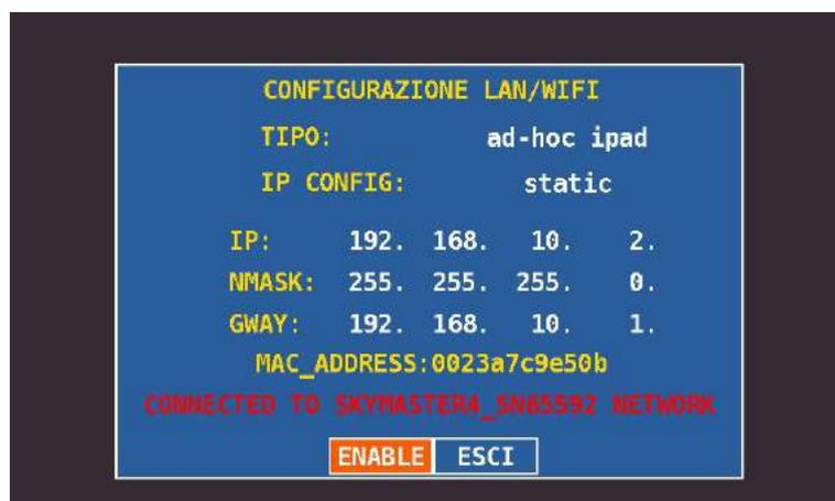
Fig. 6.4 Display della configurazione della WiFi ad-hoc per l'iPAD .
