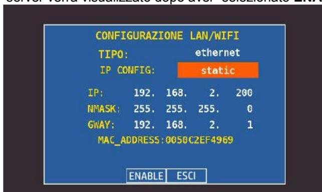
Fig. 6.1 Configurazione IP statico
