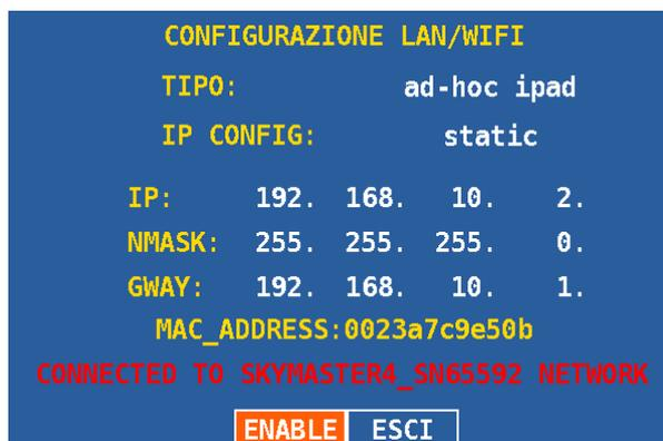
Fig. 18.1 dopo aver nel menu principale l'icona "Connect", la schermata in figura sarà visualizzata. Selezionare la rete "ad-hoc ipad" o premere il pulsante OK [7] su "ENABLE" per avviare la portante WiFi dello "SKYMASTER 4".
