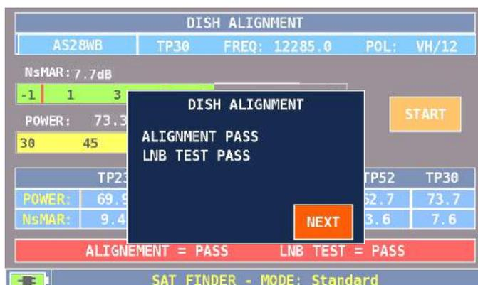
fig. 9.4 Puntamento parabola per LNB Universale ( MODE = standard): selezionando START (avvio) I test di conferma saranno eseguiti e il risultato delle misure sarà
