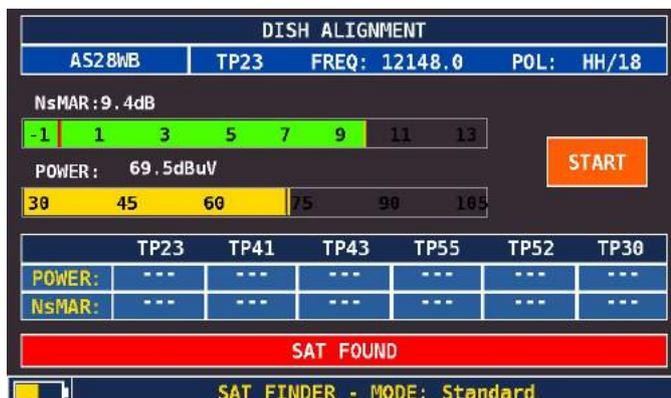
fig. 9.3 Puntamento parabola per LNB Universale (MODE = standard): Messaggio: SAT FOUND - SAT individuato
