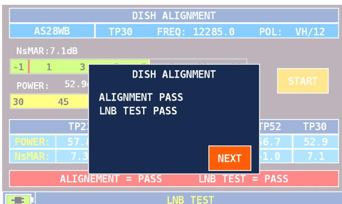
Fig. 10.2 TEST LNB. Dipendendo dal LNB selezionato lo strumento visualizzerà dei messaggi con le istruzioni riguardanti le connessioni da effettuare alle porte dell'LNB o Multiswitch prima di effettuare le misure.
