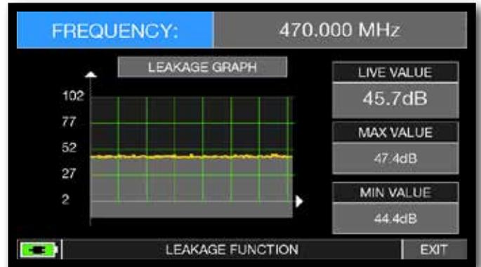
Misure di Leakage.
