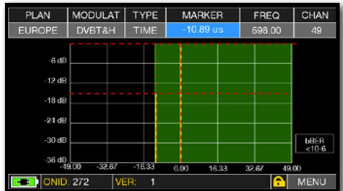
Visualizzazione MicroEchi, tocca il Marker e ruota l'encoder per selezionare l'ECO.
