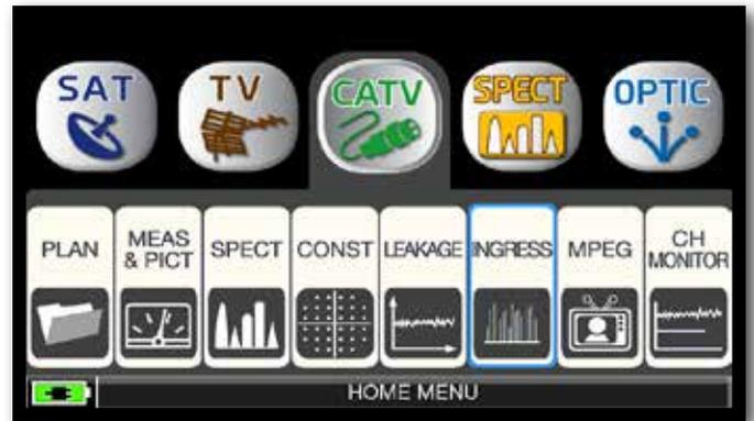
Tocca "CATV", poi "LEAKAGE" oppure utilizza l'encoder.
