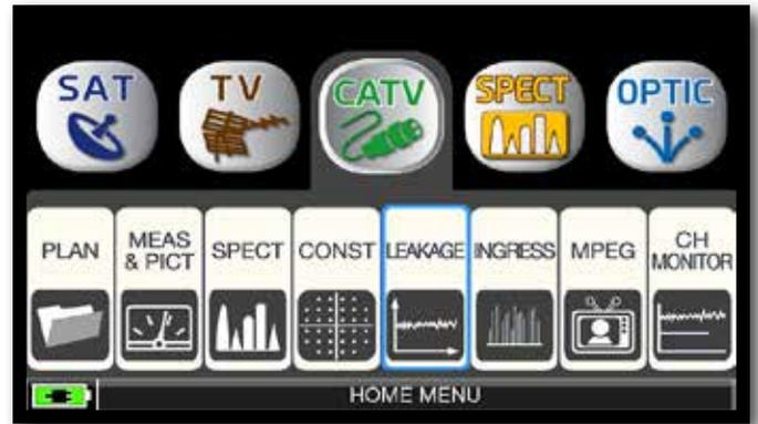
Tocca "CATV", poi "LEAKAGE" oppure utilizza l'encoder.
