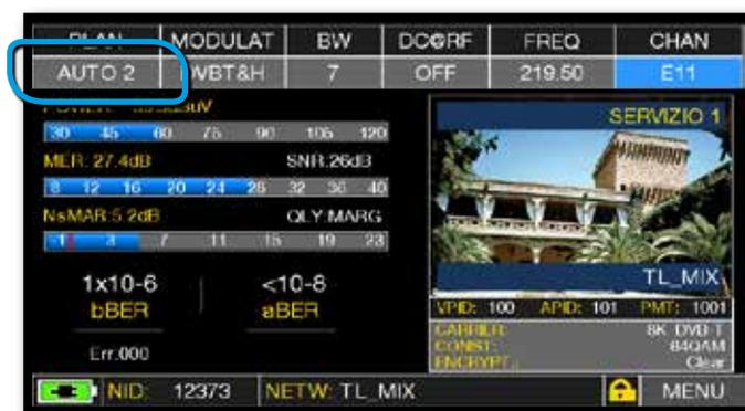
Una volta completato l'automemory il piano "AUTO" viene selezionato automaticamente.
