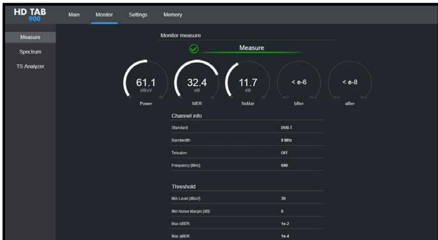
Esempio di MISURE di un CANALE TV (Standard DVB-T) e relativa schermata delle RISPOSTA ALL'IMPULSO (ECHI)
