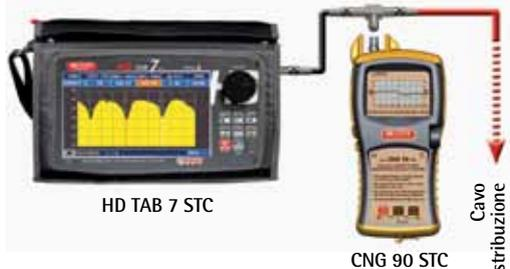
strumento mostrerà, in modalità spettro, solo il rumore calibrato. Viceversa, se è presente un disadattamento provocato, ad esempio, da un cavo in corto circuito, tagliato o non terminato correttamente con un carico da 75 ohm, sullo spettro dello strumento si creerà un'onda stazionaria. Il menu di navigazione dello strumento, attraverso i due marker, permette di selezionare i due nulli ricavando nella parte inferiore sinistra del display, ad esempio la distanza esatta dell'interruzione del cavo.
