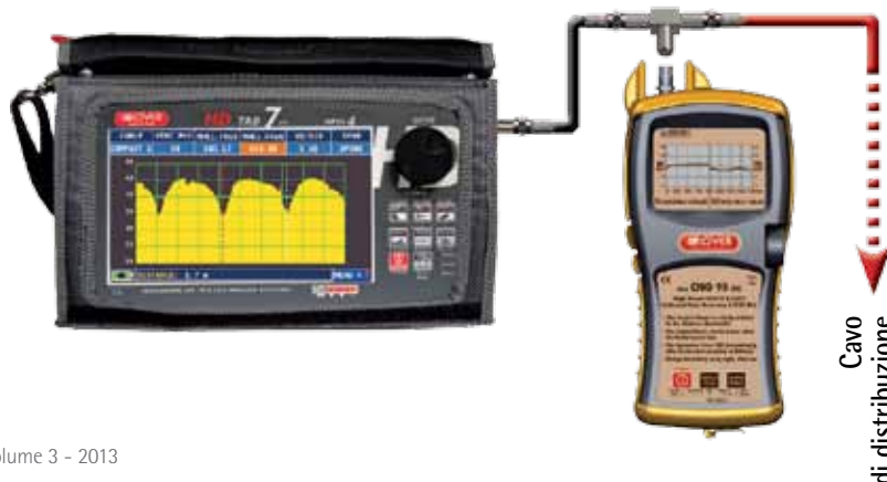
Sotto, un esempio di come si collega il CNG 90 STC ad una rete di distribuzione.
