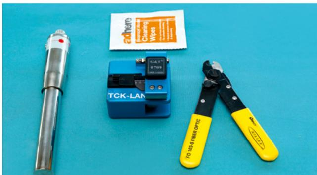
**1** L'attrezzatura necessaria per il montaggio del connettore prelappato per fibra ottica da 250  $\mu$ .
