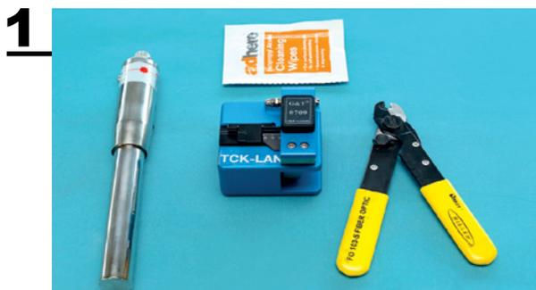
L'attrezzatura necessaria per il montaggio del giunto meccanico.
