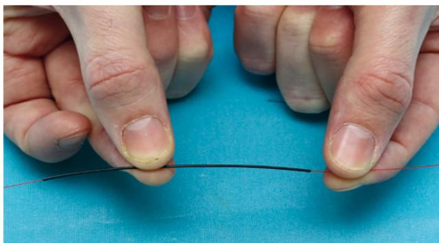
**3** Infilare il tubetto di rinforzo da 900  $\mu$ , fornito in dotazione, sulla fibra ottica da 250  $\mu$ .
