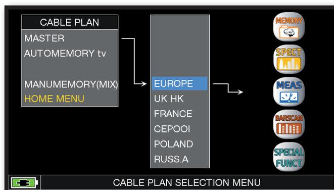
Tocca direttamente la canalizzazione desiderata, oppure utilizza l'encoder. Al termine, tocca "MEAS" per effettuare le misure o "SPECT" per visualizzare lo Spettro.
