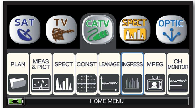
Tocca "CATV", poi "LEAKAGE" oppure utilizza l'encoder.
