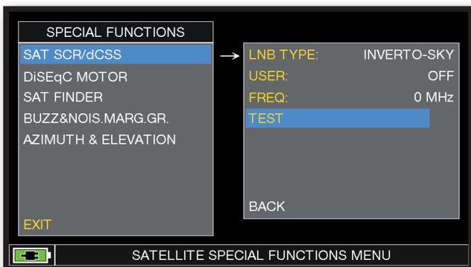
Oppure tocca "TEST" per eseguire in modalità spettro una verifica delle 4 frequenze in uscita (user 1-4) dal LNB/multiswitch.
