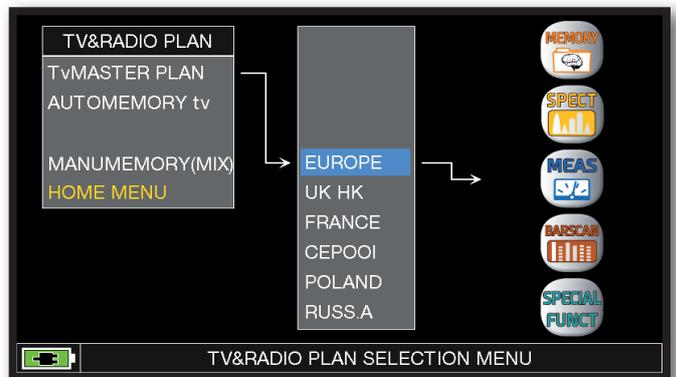
Tocca direttamente la canalizzazione desiderata, oppure utilizza l'encoder. Al termine, tocca "MEAS" per effettuare le misure o "SPECT" per visualizzare lo Spettro.
