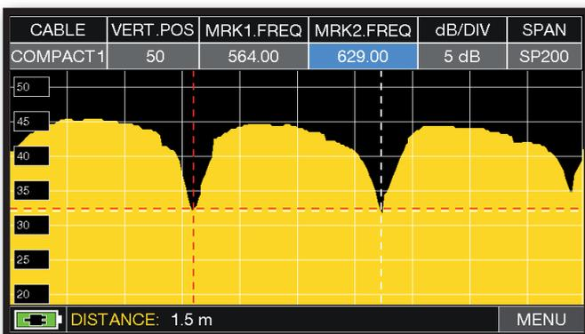
Leggi nel campo DISTANCE il valore del disadattamento del cavo: esempio 1,5 m
