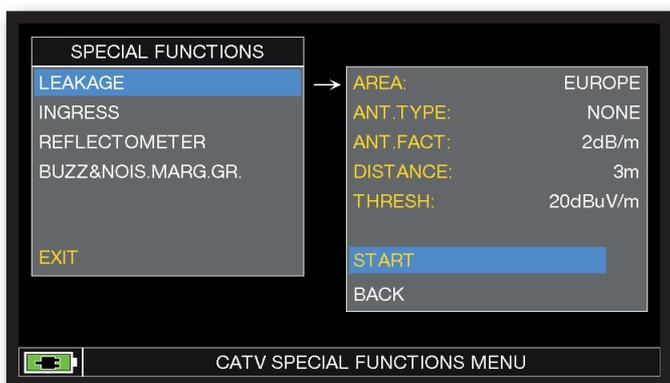
Imposta i parametri desiderati, al termine tocca "START" per avviare le misure di leakage.
