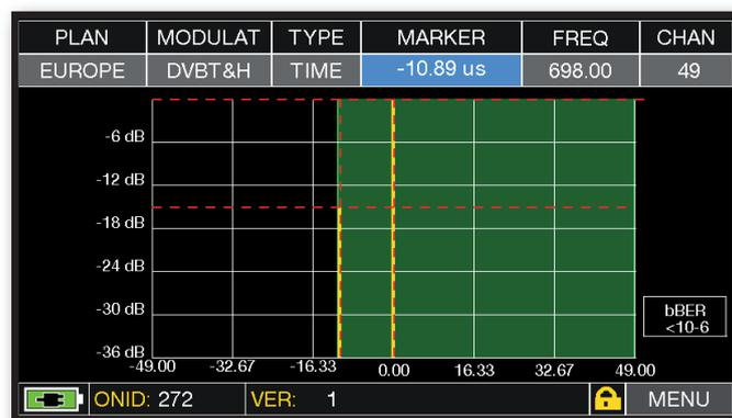
Visualizzazione MicroEchi, tocca il Marker e ruota l'encoder per selezionare l'ECO.
