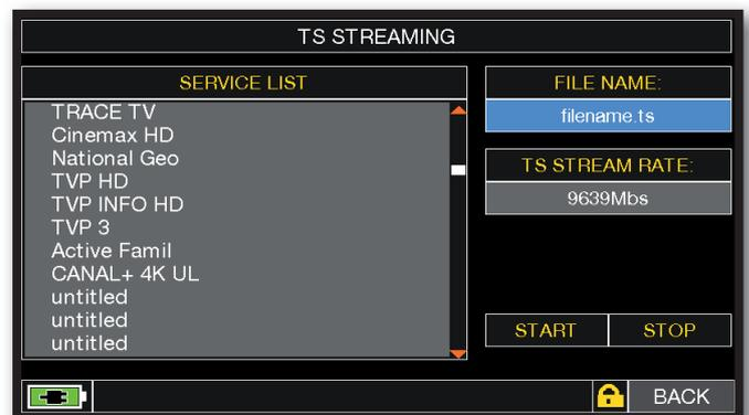
Tocca "FILE NAME" e digita, tramite la tastiera, il nome del file del Transport Stream da registrare. Se la memoria USB non viene inserita appare la scritta "INSERT USB"
