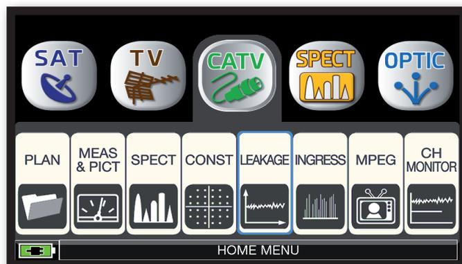
Tocca "CATV", poi "LEAKAGE" oppure utilizza l'encoder.
