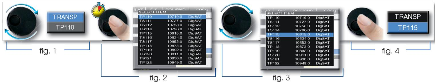
Selezionare la frequenza e impostare il valore tramite la tastiera numerica:
