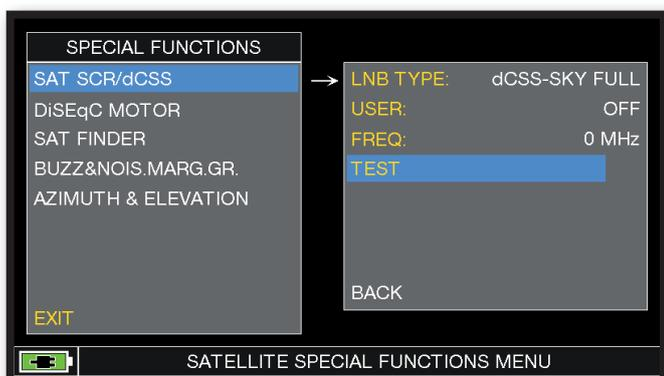
Oppure tocca "TEST" per eseguire in modalità spettro una verifica delle 12 frequenze in uscita (user 5-16) dal LNB/multiswitch.
