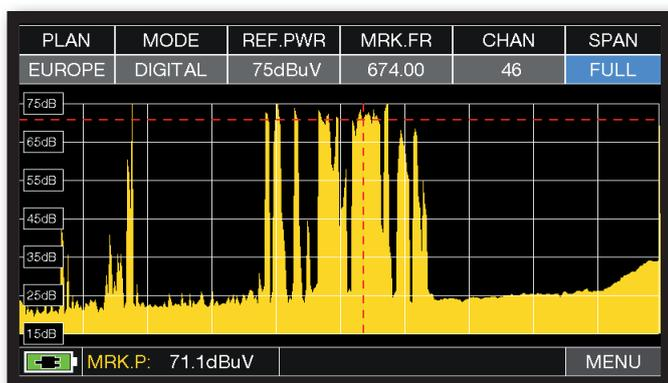
Spettro "TV" SPAN FULL (da 5 a 1.250 MHz).
