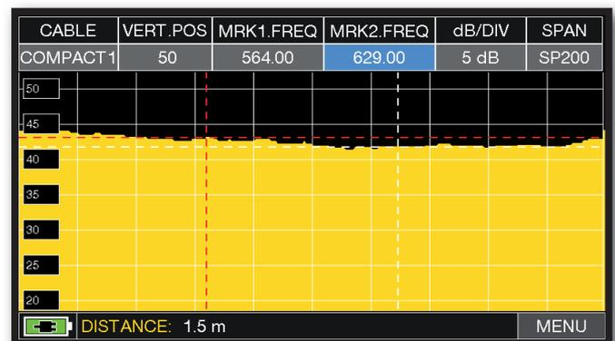
Leggi nel campo DISTANCE il valore del disadattamento del cavo: esempio 1,5 m
