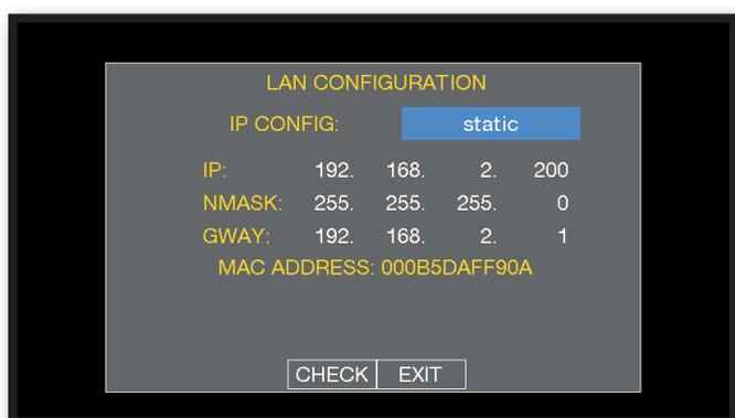
Tocca "IP CONFIG" e seleziona "STATIC", inserisci i parametri "IP", "NMASK" e "GWAY"
