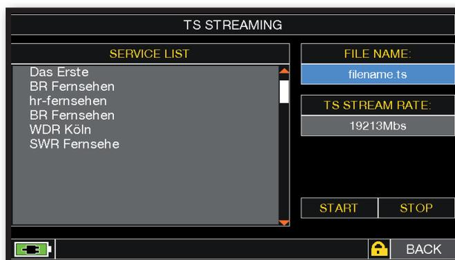
Tocca "FILE NAME" e digita, tramite la tastiera, il nome del file del Transport Stream da registrare. Se la memoria USB non viene inserita appare la scritta "INSERT USB"
