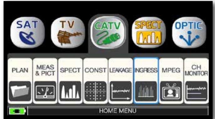
Tocca "CATV", poi "LEAKAGE" oppure utilizza l'encoder.
