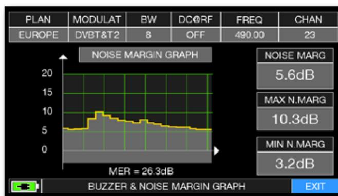
Buzzer e Grafico relativi all'andamento del NOISE MARGIN del canale TV/CATV sintonizzato in funzione del tempo.
