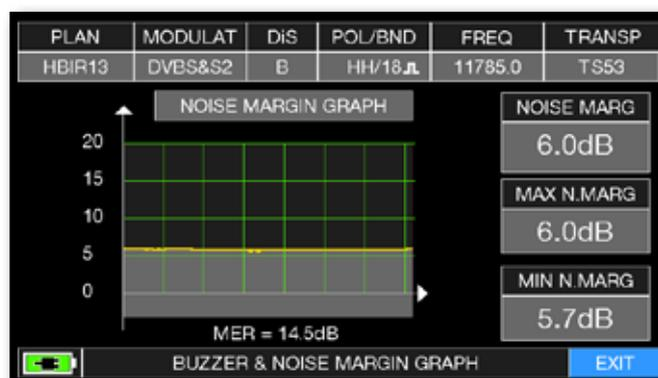
Buzzer e Grafico relativi all'andamento del NOISE MARGIN del Transponder Satellitare sintonizzato in funzione del tempo.
