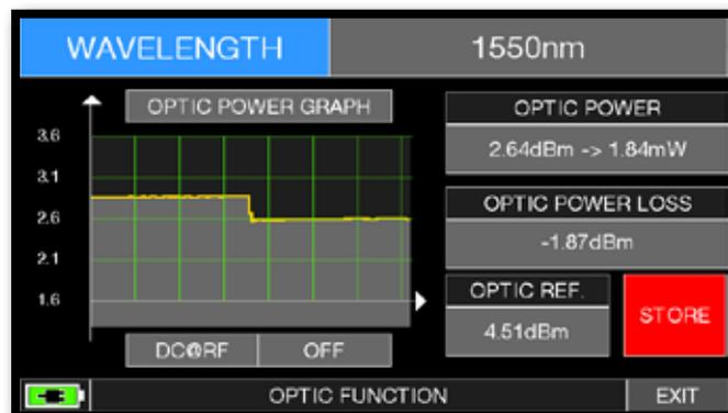
Nel campo "OPTIC POWER LOSS" viene indicato il valore di attenuazione ottica rispetto al valore memorizzato (Optic REF): ad esempio - 1.87 dBm.
