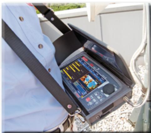
**3** L'**aletta parasole** ti permette una migliore visibilità proteggendo dal sole il tuo display ad alta luminosità.
