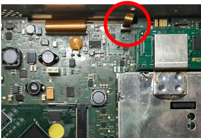
Fig.1 Cable plano de pantalla táctil para el tipo de pantalla antiguo.
