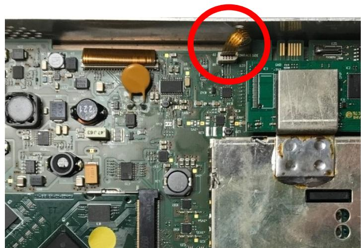
**Fig.2** Nuovo display Cavo Piatto del Touch screen ruotato di 180°
