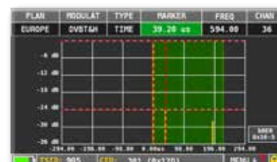
MASURE ECHI in reti SFN, con impulse response in tempo reale, l'area verde mostra l'intervallo di guardia
