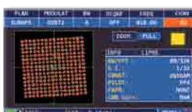
Costellazione **DVB-T2** ruotata 256 QAM mod., sulla destra i parametri di modulazione relativi e M-PLP
