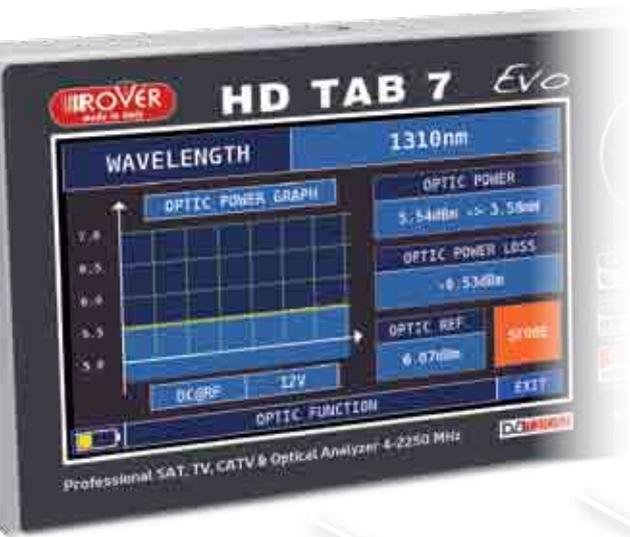
Lo strumento dispone di un convertitore ottico interno in grado di misurare la potenza e l'attenuazione ottica, di effettuare misure RF dall'ingresso ottico, decodificare i servizi e visualizzare lo spettro.
