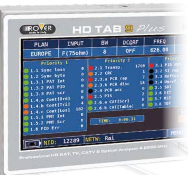
Lo strumento dispone di un analizzatore di TS integrato che fornisce un monitoraggio completo degli allarmi 1-2-3 con priorità ETR101-290. Esso analizza i transport stream, sia demodulati da uno degli ingressi RF, iniettati tramite il connettore di ingresso ASI o ricevuti tramite l'interfaccia GbE.
