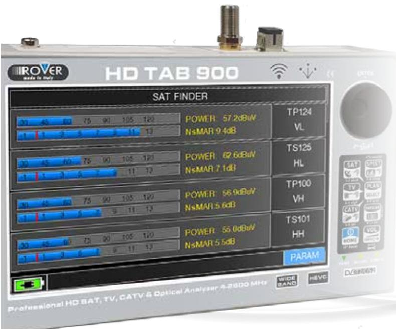
Grazie a questa funzione l'utente può controllare la qualità di 4 transponders satellitari contemporaneamente. E' inoltre utile per controllare il corretto funzionamento delle 4 polarità dell'LNB.
