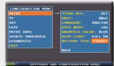
Fig. 3: Per leggere la durata collegate la carica batteria, selezionare METER e BATTERY TEST: 175AGEY
