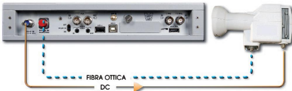
Schema di collegamento dell'HD TAB 9 a un convertitore (LNB) ottico. Lo strumento, inoltre, è in grado di fornire la corrente di tele-alimentazione direttamente al convertitore ottico tramite il connettore di ingresso RF-IN.
